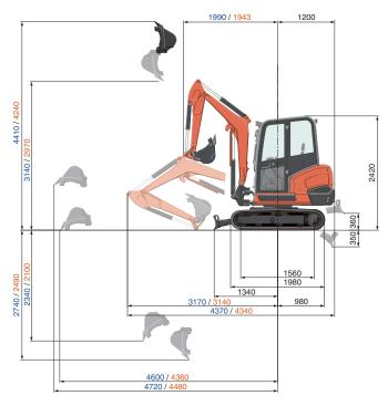
1300 mm Löffelstiel 1050 mm Löffelstiel Einheiten in: mm
